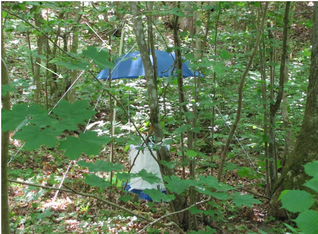
Figur 2. BG-fälla placerad i en buske. En stödbyggsliknande konstruktion av plast fasthåller med fyra rep BG fällan och det regnskyddande paraplyet.
