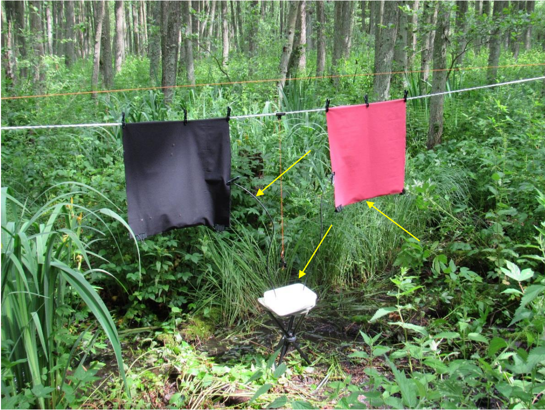
Figur 3. Försöksuppställning för studie om hur olika tygfärger attraherar myggor. Pilarna visar torris-boxen, den svarta slangen som leder CO 2 till vävnaden, och BG-'attractant' i botten av det ihopveckade tygstycket.
